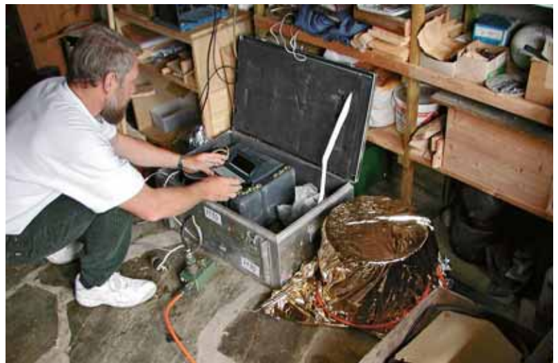
Figur 3: Programmering af en opstillet seismograf, som er pakket ind i reflekterende folie for at begrænse temperatursvingninger.
